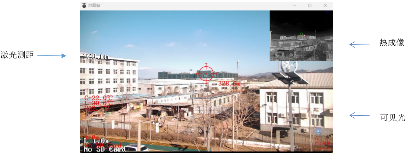
图 3-4-1-1 吊舱开机初始化画面
