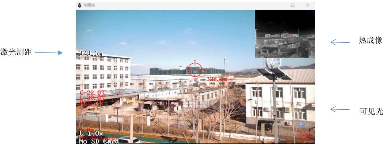
图 3-4-1-1 吊舱开机初始化画面
